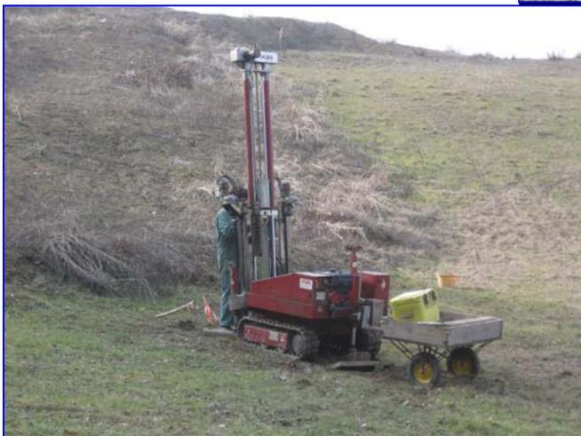
**Foto di alcune delle prove penetrometriche eseguite nell'Area di Studio posta più a valle**
